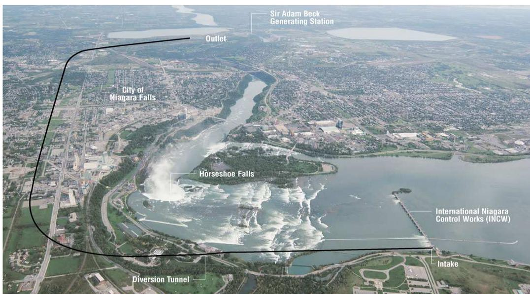
Figure 51. Galerie de déviation sous les chutes du Niagara- NTFP
