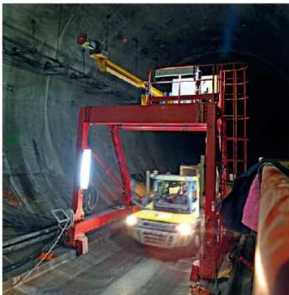
Figure 55. Système d'instrumentation laser
