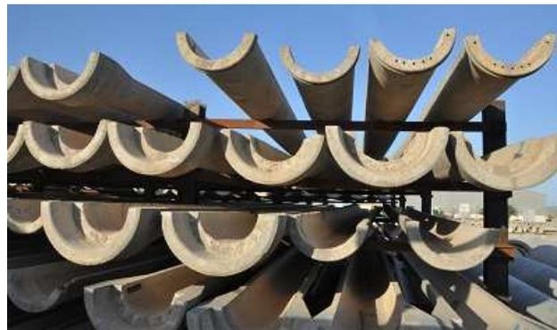
Figure 15. Exemples d'éléments semi-cylindriques utilisés pour le fretage par fil d'acier
